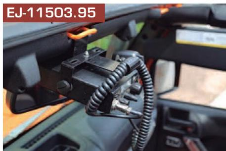
Soporte de radio. Se monta encima del espejo retrovisor.
