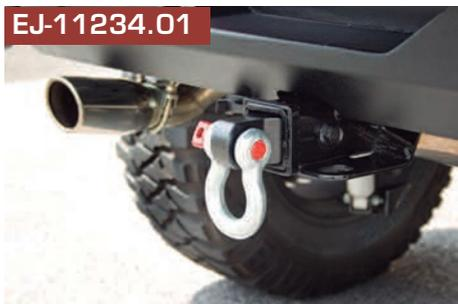
Conjunto de enganche. Hasta 4.300 kilos. No está diseñado para remolcar.
