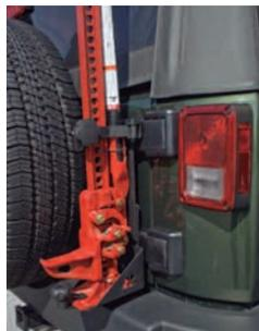
Soporte gato mecánico. Se sujeta a la puerta trasera con bisagras.
