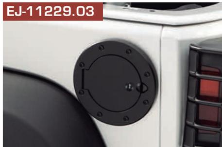
Tapa depósito de combustible de acero resistente y con bloqueo. Acabado de pintura en polvo negro semibrillante. *Adaptable a Wrangler JK (2007-2017)*
