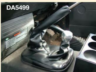
Sustituye el fuelle de la palanca de cambios y transfer por uno más resistente y duradero.
