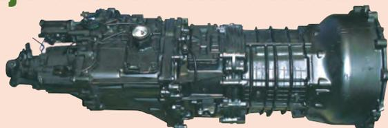
Caja cambios completa Montero DID con motor eléctrico para accionar el transfer
