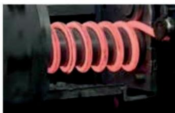
El calentamiento preciso de la longitud y el diámetro correcto, y el diámetro de varillas de acero de calidad superior, seguido del moldeado en caliente en mandriles de precisión, para garantizar la consistencia.
