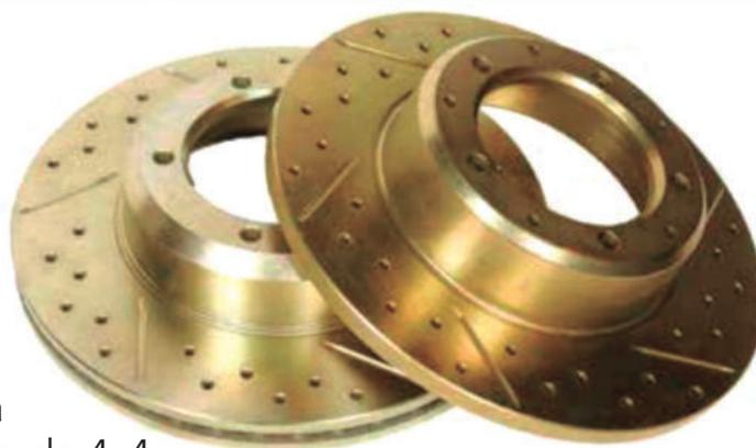
Los discos de freno Terrafirma ofrecen un mayor agarre en frío y una excelente resistencia al desgaste en la mayoría de las aplicaciones de frenado de 4x4.
