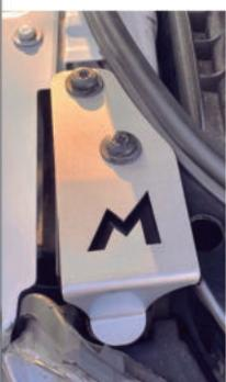
Estas protecciones antirrobo de fácil instalación impiden que la etiqueta de seguridad sea arrancada, lo que significa que los faros no pueden ser retirados sin abrir el capó. Son fáciles de instalar utilizando el montaje existente, sin necesidad de perforar.
